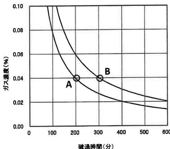
オ 有機ガス用防毒マスク及び有機ガス用 G-PAPR の吸收缶は、有機ガスの種類により防毒マスクの規格第 7 条及び改正規格第 7 条に規定される除毒能力試験の試験用ガス（シクロヘキサン）と異なる破過時間を示すので、対象物質の破過時間について製造者に問い合わせること。
